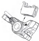
Figura 2-5 Rimozione/montaggio delle ganasce dei freni e degli accessori
