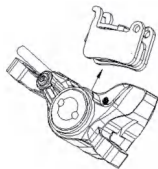
Rysunek 2-5 Usuwanie/montaż szczęk hamulcowych i akcesoriów
