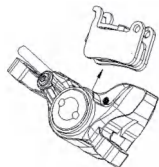
Abbildung 2-5 Entnahme/Montage der Bremsbeläge und Zubehörteile
